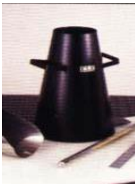
شكل رقم (1) قالب اختبار الهبوط وقضيب الرص
