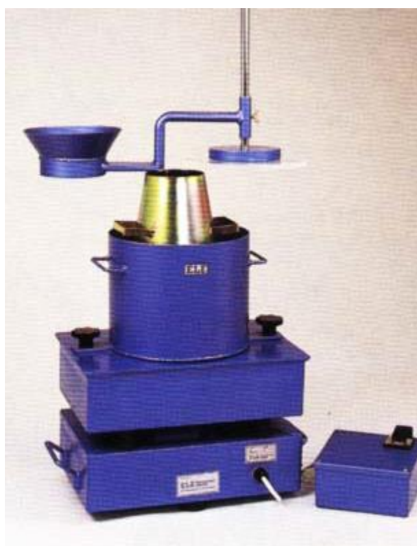
شكل رقم (8) جهاز إعادة التشكيل Vebe
