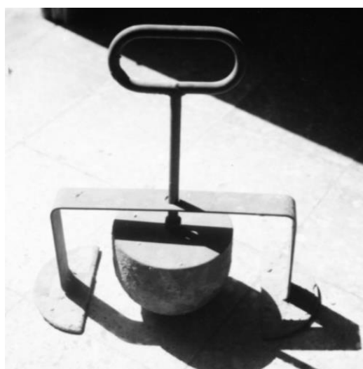
شكل رقم (6) جهاز كرة كيللي لقياس القوام
