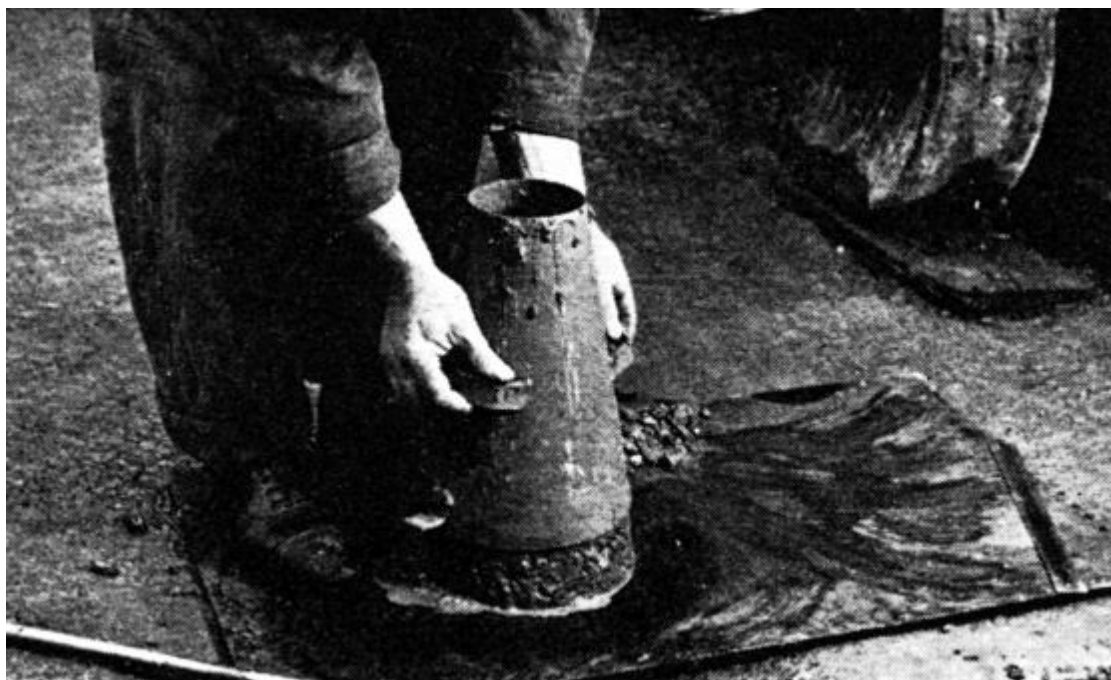
شكل رقم (2) رفع القالب بعد ملئه مباشرة
