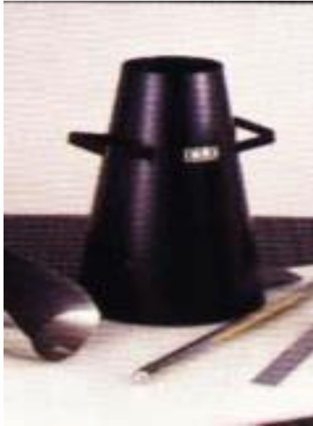
شكل رقم (1) قالب اختبار الهبوط وقضيب الرص
