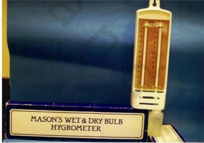
صورة (٦). توضح جهاز الهيجروميتر ذو الترموترين المبلل والجاف لقياس الرطوبة النسبية .
