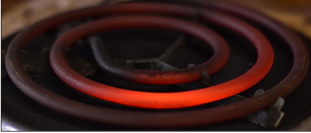
شكل (4): ملف التسخين الكهربائي
