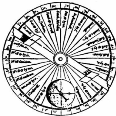
شكل (٥-٢) جهاز الإسطرلاب لقياس الزوايا
