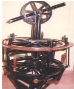
شكل (٥-٣) نماذج لأجهزة ثيودوليت قديمة لقياس الزوايا
